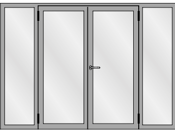
Zweiflügelige Türe mit zwei festen Seitenteilen Porte à deux vantaux avec deux parties latérales fixes Double leaf door with two fixed side lights
