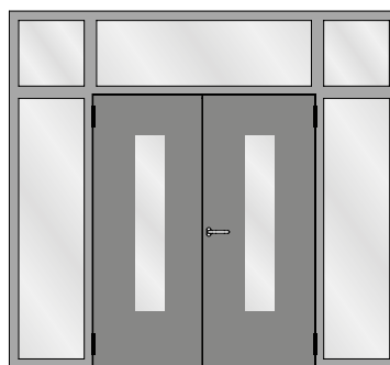
Verblechte zweiflügelige Türe mit zwei festen Seitenteilen und festen Oberlichtern Porte tôle à deux vantaux avec deux parties latérales fixes et impostes fixes Sheet metal double leaf door with two fixed side lights and fixed top lights
