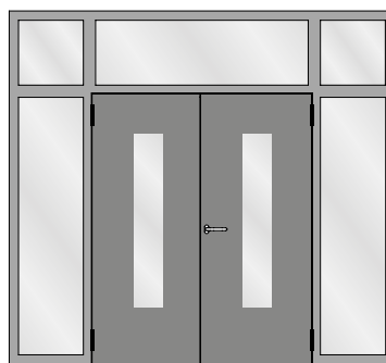
Verblechte zweiflügelige Türe mit zwei festen Seitenteilen und festen Oberlichtern Porte tôleée à deux vantaux avec deux parties latérales fixes et impostes fixes Sheet metal double leaf door with two fixed side lights and fixed top lights
